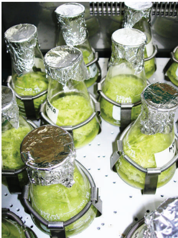
Gráfica 1. Extracción y fermentación simultáneas del azúcar contenido en partículas del tallo de sorgo dulce suspendidas en agua
