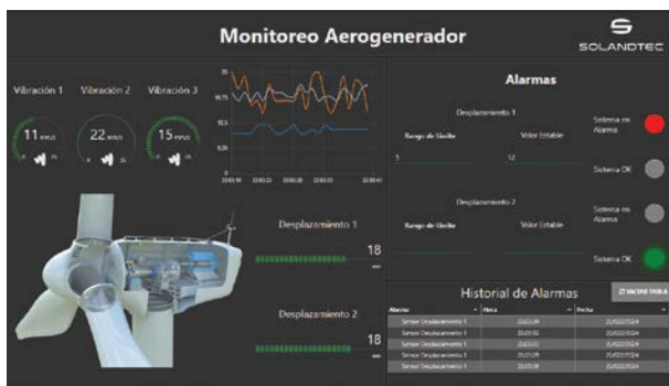
Sistema inalámbrico de monitoreo que mide la vibración de los álabes y el desplazamiento de la caja de engranajes en aerogeneradores, desarrollado por Solandtec . Imagen: Gerardo Martínez.
