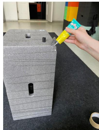
Trage eine geringe Menge dickflüssigen Sekundenkleber oder einen für EPP geeigneten Klebstoff auf die zu klebende Ecke auf. Übe festen Druck auf die Ecke aus, um den Klebstoff gleichmäßig zu verteilen und eine sichere Haftung zu gewährleisten.
