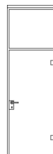
752 TE 03 Zarge raumhoch mit Kämpfer Türblatt Normhöhe Oberlicht 752 TE 03 Room-height frame with transom, door standard height, overhead window
