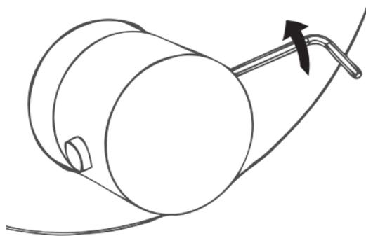
Avec la poignée toujours sous tension à son maximum, serrez la vis à l'aide d'une clé allen pour fixer la poignée.
