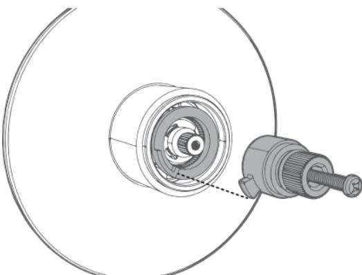
Avec la température de l'eau réglée à 48,9°C, installez l'adaptateur de manière à ce qu'il soit aligné avec le limiteur en plastique. Bloquant la rotation anti-horaire de la cartouche.
