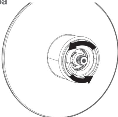
Avec l'aide d'un thermomètre, calibrer la température de l'eau sortant du bec à 48,9°C (max) en tournant la cartouche (partie grisée).
