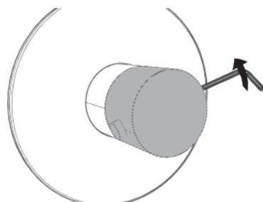
Avec la poignée toujours sous tension à son maximum, serrez la vis à l'aide d'une clé allen pour fixer la poignée.
