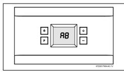
Fig. 49 A8- Startup Delay
