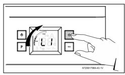
Fig. 60 Gas adjust - L1 parameter
