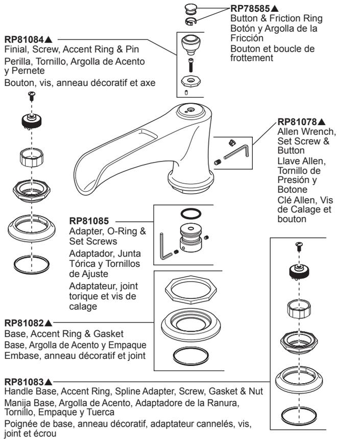
**Models / Modelos / Modèles T67460-▲LHP & T67461-▲LHP**
