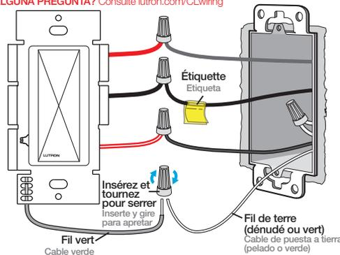
REMARQUE : Un seul gradateur peut être utilisé dans un circuit va-et-vient.
