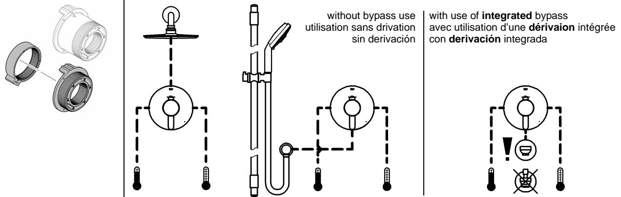
**PBV trim type #2 (integrated two way diverter) / Équilibrer depression de type #2 (inverseur à deux voies) /**
