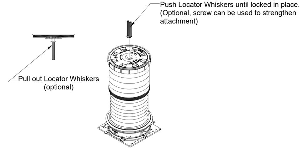
**RE-INSTALL CAP & INSERT LOCATOR WHISKERS.**
