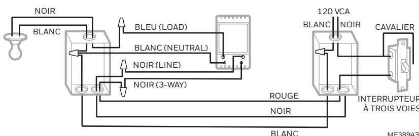
Relier le fil « LOAD » du PLS750C/PLS751C au fil « commun » identifié lorsque vous avez enlevé l'ancien interrupteur. Relier le fil « NEUTRAL » aux fils neutres (blancs). Relier les fils « LINE » et « 3-WAY » aux deux fils restants. Pour l'autre interrupteur à 3 voies, relier le fil de raccord (fourni) entre la borne « commun » et la borne sur laquelle le fil « LINE » du PLS750C/PLS751C est relié.
