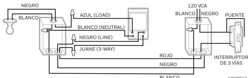
Conectar el cable "LOAD" del PLS750C/PLS751C al cable "común", identificado cuando se retiró el antiguo interruptor. Conectar el cable "GND" al terminal de puesta a tierra en la caja de electricidad. Conectar los cables "LINE" y "3-WAY" a los dos cables restantes. En el otro interruptor de 3 vías, conectar el cable de puente (provisto) entre el terminal "común" y el terminal en el que está conectado el cable "LINE" del PLS750C/PLS751C.
