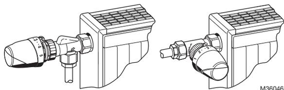
Fig. 2. Positions d'installation acceptables.
