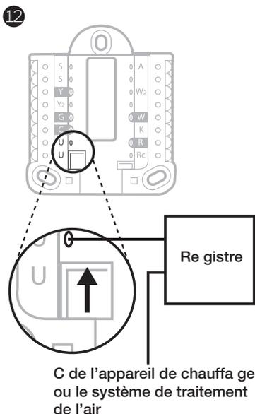
C de l'appareil de chauffa ge ou le système de traitement de l'air
