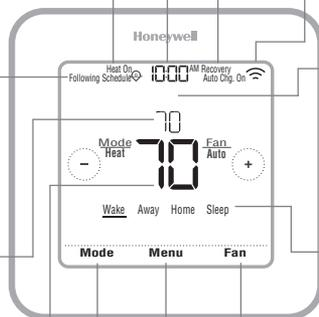
L'écran s'active lorsque la zone centrale de la température affichée est pressée. L'écran reste allumé pendant 45 secondes. La luminosité peut être réglée dans le menu.
