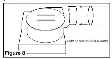
**NOTE:** Pour le raccordement du conduit ovale, presser un conduit standard rigide circulaire de 4 po pour former une forme ovale puis suivez les instructions à *l'étape 1*.
