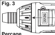
Pour régler l'accouplement, tournez l'anneau de réglage d'accouplement pour aligner la position de réglage choisie (1-15) sur la marque imprimée sur le boîtier du moteur, tel qu'indiqué. Les spécifications de couple susmentionnées sont approximatives et basées sur une batterie à pleine charge.
