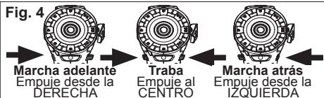
Para **avanzar** (el giro es en el sentido de las manecillas del reloj), se presiona el interruptor de control colocado al lado derecho del taladro. **Verificar la dirección del giro antes de usarlo.**
