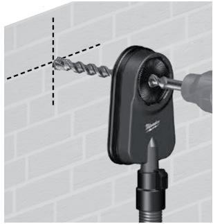
2. Conecte la manguera de la aspiradora al puerto de polvo utilizando el adaptador 49-90-1959.
