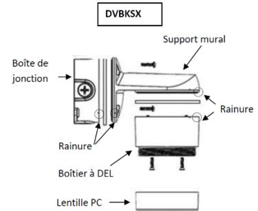
Si vous utilisez une lentille de verre au lieu de la lentille PC, placez le joint caoutchouc de 3.2po à l'intérieur du boîtier à DEL.
