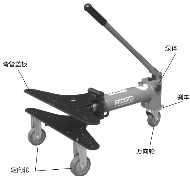
图1 液压弯管器滚轮装配
