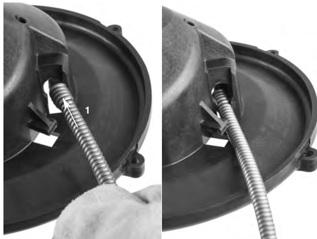
Figure 15 – Arrimage du câble sur le dosseret du tambour
