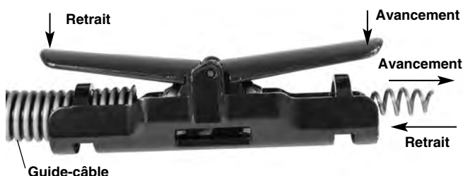
Figure 9 – Leviers d'avancement et de retrait
