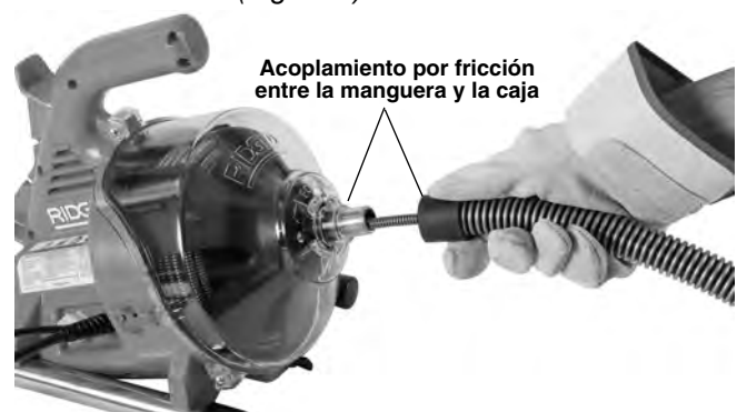
Figura 4 – Alimentación del cable dentro de la manguera-guía
