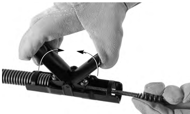
Figure 5 – Passage du câble à travers le système AUTOFEED Assembly
