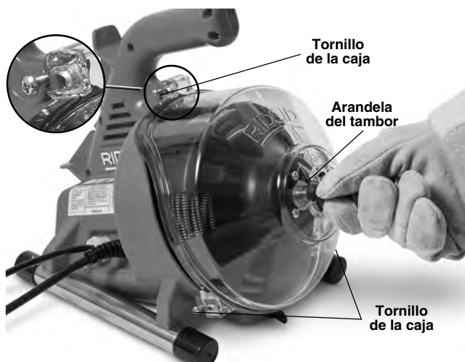
Figura 13 – Apertura de la limpiadora de desagües
