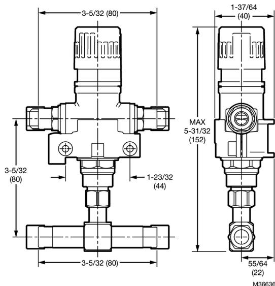
Fig. 1. Dimensiones de UMV500-LF/U en in (mm).
