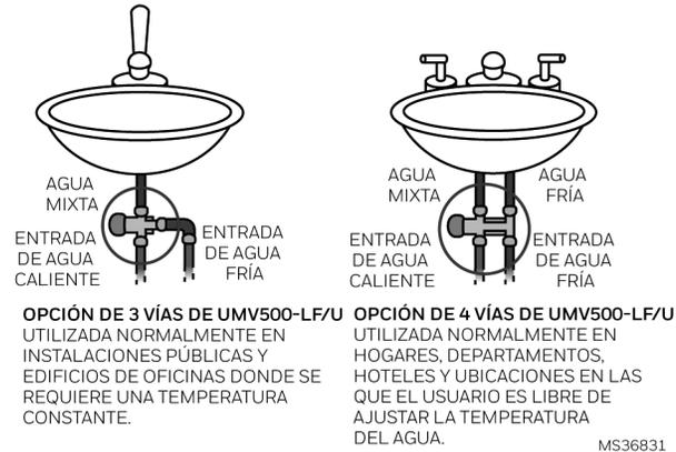
Fig. 3. Instalación de UMV500-LF/U.
