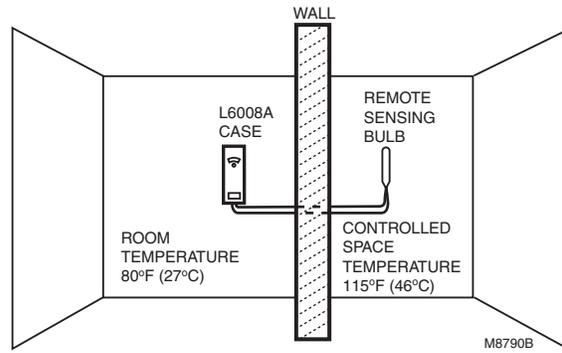
**Fig. 33. L6008A calibration.**
