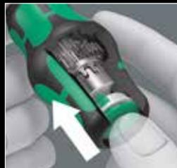
Robustes und wartungsfreies Getriebe aus Stahl (maximales Drehmoment 14 Nm). Sollten die Sperrzähne exakt aufeinander stehen, lässt sich der Knopf evtl. schlecht drücken – in diesem Fall oberes Heft-Teil etwas nach links oder rechts drehen.
