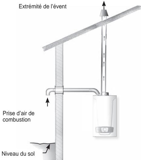
**FIGURE 6-14- Évén à tuyau double sur le toit**
