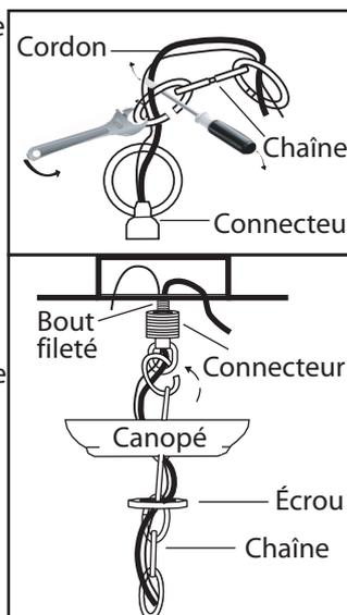
6. Pour relier la chaîne au luminaire, ouvrez l'un des maillons à l'aide d'un tournevis et d'une clé. Fermez le maillon. Enfilez le cordon électrique et le fil de la mise à la terre en travers des maillons de la chaîne.
