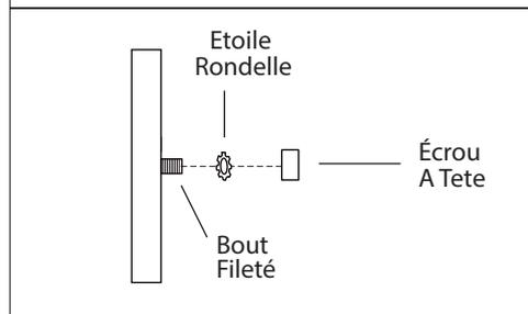
4. Une fois les connexions terminées, poussez soigneusement les fils et les connecteurs dans la boîte électrique en vous assurant qu'aucun fil dénudé (sur les fils noirs et blancs) est visible des connecteurs. Positionner l'ouverture dans le lustre sur le bout fileté et fixer en place à l'aide de la rondelle en caoutchouc.
