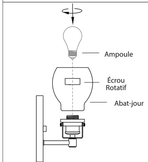
5. Retirez l'écrou rotatif de la douille. Positionnez l'abat-jour sur la lampe et fixez-le solidement avec l'écrou rotatif.
