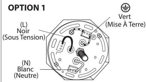
2. OPTION 1: Poussez pour brancher les fils de la boîte électrique (courant de la maison) dans les insertions appropriées. Noir (sous tension), blanc (neutre), vert (mise à terre)
