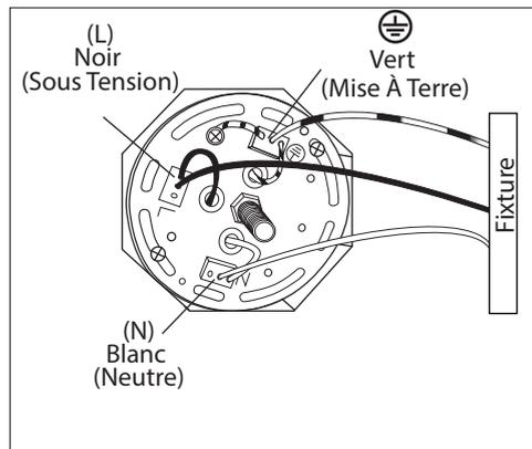
3. Branchez (poussez) les fils électriques du luminaire dans les insertions appropriées. Noir (sous tension), Blanc (neutre), vert (mise à terre)
