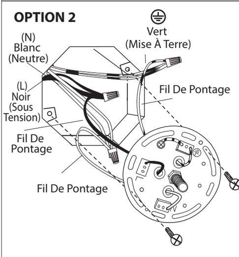
OPTION 2: Lorsqu'il y a des multiples de fils dans la boîte électrique, vert (mise à terre), noir (sous tension), blanc (neutre), poser seulement qu'un de chaque fil soit vert, noir et blanc avant pour la connexion. Retirez 7mm de la gaine d'un fil de pontage de 6" (AWG 12-24) inclus. Passez les fils Noir, Blanc et Vert à travers les trous fournis dans le support de montage. Posez (poussez) les fils dans les insertions appropriées.
