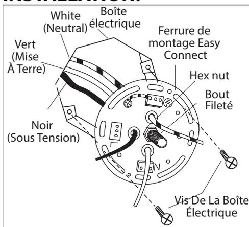
1. Posez le bout fileté à la ferrure de montage. Ajustez le jusqu'à ce qu'il dépasse le trou à l'arrière de la fixture et fixez en place à l'aide de l'écrou hexagonal. Passez les fils Noir, Blanc et Vert à travers les trous fournis dans le support de montage. Posez la ferrure de montage à la boîte électrique à l'aide des vis (en sus).
