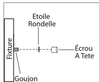
**4.** Poussez délicatement les fils à l'intérieur de la boîte électrique et placez le luminaire sur les goujons sur la ferrure de montage. Serrez le luminaire en place à l'aide des écrous étoilés et les écrous à capuchon.
