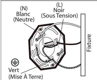
**1.** Posez la ferrure de montage Easy Connect™ à la boîte électrique à l'aide des vis de la boîte électrique (en sus).
