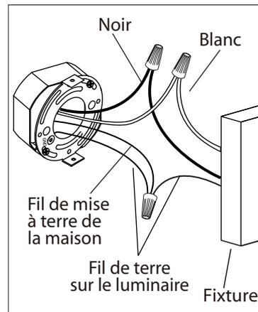
3. Branchez les fils de la mise a terre (cuivre nu ou vert) de votre montage au fil de la mise a terre (cuivre nu ou vert) ou vis de la mise a terre dans la boite électrique. Posez le fil noir de la fixture au fil noir dans la boite électrique et posez le fil blanc de la fixture au fil blanc dans la boite.
