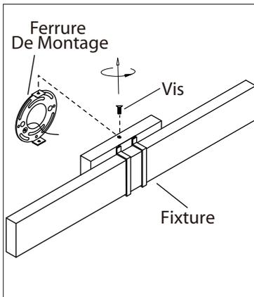
1. Retirer la ferrure d'installation du luminaire en retirant les 2 vis.
