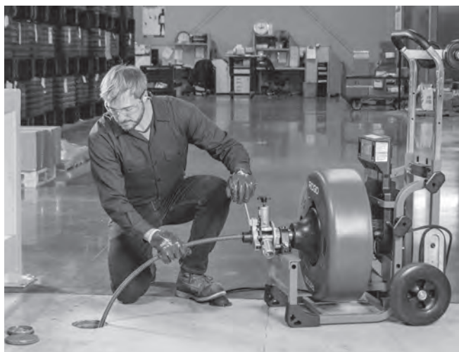
Figura 21 – Funcionamiento de la máquina K-750 con AUTOFEED
