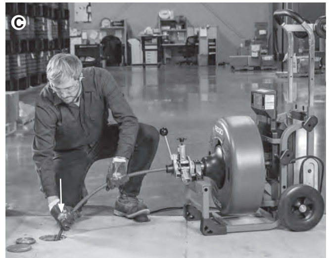
Figura 20 A, B, C – Operación de alimentación manual
