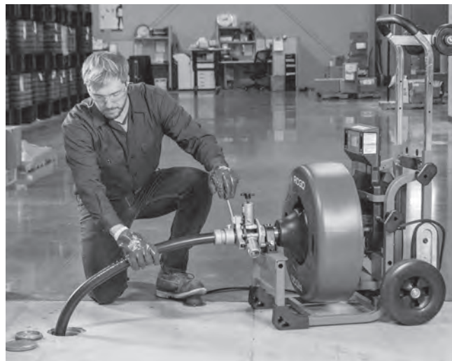
Figure 23 – Utilisation de l'appareil avec guide-câble
