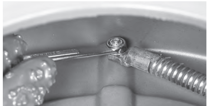
Figura 30 – Perno de anclaje del acoplamiento flexible pigtail
