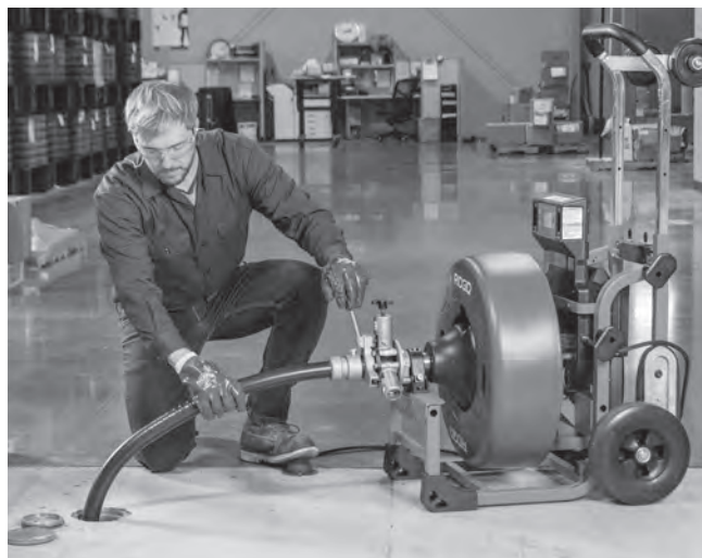
Figura 23 – Uso de la máquina con manguera guía
