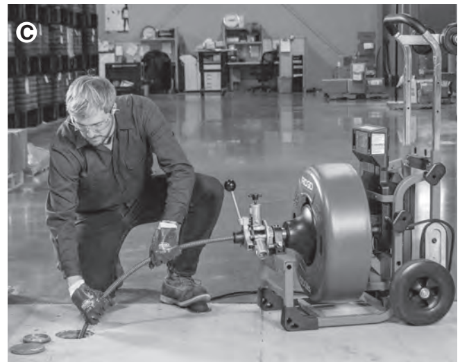
Figure 20A,B,C – Avancement manuel du câble
