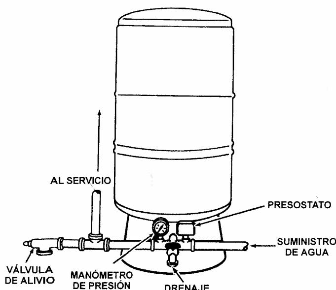
El tanque de sistema de agua debe instalarse lo más cerca posible del presostato (a 24 pulgadas o menos), a fin de reducir los efectos adversos de las pérdidas por fricción y las diferencias de elevación.
