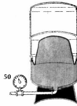
3. La presión del tanque se eleva. El agua continúa entrando hasta que se alcanza la presión de corte de la bomba y ésta se desactiva, lo cual indica que el tanque está lleno.
