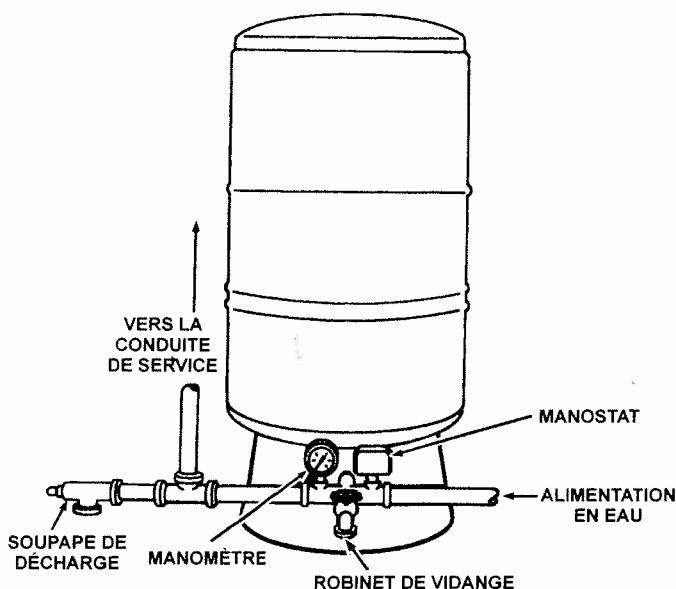
Il faut installer le réservoir le plus près possible du manostat (24 po/ 61 cm ou moins) pour réduire l'incidence de la perte de charge par frottement et de la dénivellation.
