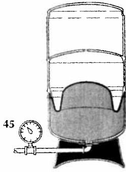
4. La presión en la cámara de aire fuerza la entrada de agua al sistema cuando se demanda, sin que la bomba funcione de inmediato. Cuando la presión finalmente disminuye al nivel de activación de la bomba, el interruptor la pone en funcionamiento para que se repita el ciclo de llenado.
