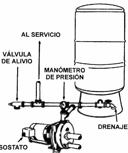
4. Si la presión de trabajo de su sistema puede rebasar los 100 PSIG (689.5 kPa) (como es el caso de la mayoría de las bombas sumergibles), instale cerca del tanque una válvula de alivio de presión (con una capacidad nominal de 100 PSIG (689.5 kPa) o menos, pero mayor que la presión de apagado). La válvula debe ser del mismo diámetro que la tubería de salida del tanque. Esto no es necesario en las unidades de bombas eyectoras montadas en tanques.
