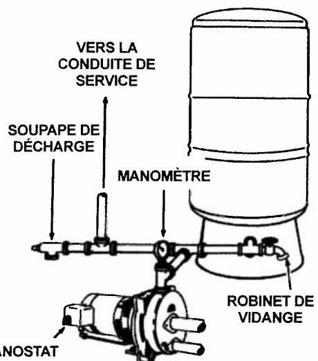
4. Si le système risque de produire une pression de service supérieure à 100 lb/po<sup>2</sup> (689,5 kPa), ce qui est généralement le cas des systèmes avec pompe submersible, intégrer au système une soupape de décharge (avec pression nominale de 100 lb/po<sup>2</sup> (689,5 kPa) ou moins, mais supérieure à la pression de coupure) près du réservoir. La soupape doit avoir le même diamètre que la sortie du réservoir. Cette opération n'est pas nécessaire pour les réservoirs avec une pompe à jet.
