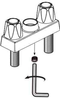
Le robinet de buanderie sont munis d'un obturateur de 1/4 po NPT qui permet de raccorder un tuyau d'amorçage de garde d'eau. Enlevez l'obturateur au moyen d'une clé Allen (hexagonale) de 3/16 po et jetez-le. Raccordez la ligne d'amorçage de garde d'eau conformément aux codes de plomberie locaux.
