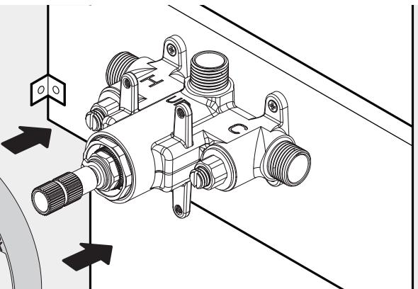
Remonter le gabarit de plastique pour les étapes futures et pour **protection**. / Reinstall the plastic template for future steps and for **protection**.
