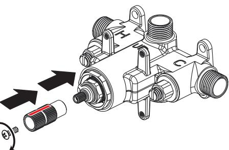
E Repositionner le pignon avec la ligne de couleur vers le haut. / Reposition the stem with the color line up.
