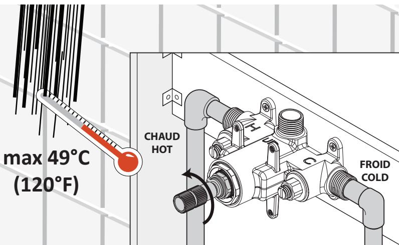
Ouvrir l'eau au Maximum d'eau chaude et vérifier la température à l'aide d'un thermomètre. / Open the water at Maximum hot water and check the temperature with a thermometer.
