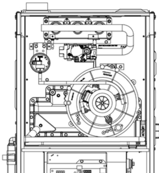
ÉVACUATION À DROITE - INSTALLATION DU DRAIN À GAUCHE
