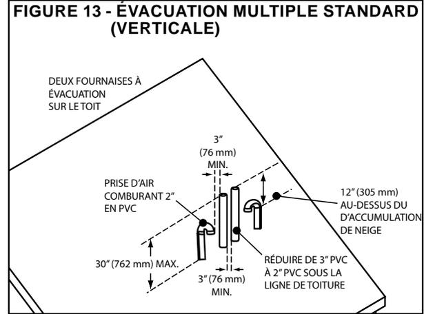
Lorsque plusieurs fournaises sont installées à proximité l'une de l'autre, chacun des ensembles de prise d'air comburant et de terminaison d'évacuation supplémentaires doit se trouver à au moins 12" (305 mm) l'un de l'autre.
