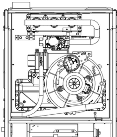
ÉVACUATION À GAUCHE - INSTALLATION DU DRAIN À DROITE
