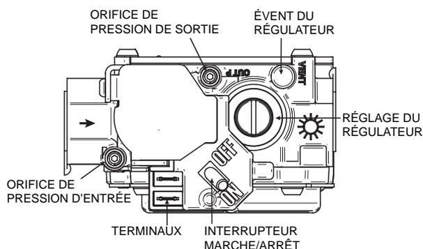
FIGURE 29 - ENSEMBLE DE VÉRIFICATION DE LA PRESSION DE LA SOUPAPE
