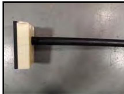
2. Si vous faites l'installation avec du PVC, utilisez le tuyau de 1/2". Si vous faites l'installation avec du PVC-C, utilisez le tuyau de 5/8". Glissez le tuyau approprié sur la sortie du purgeur de condensat et coupez-le à égalité avec l'extrémité de la sortie. Le tuyau de caoutchouc restant devrait être à égalité avec la sortie du purgeur de condensat. La longueur du tuyau restant devrait convenir à toutes les orientations de la fournaise
