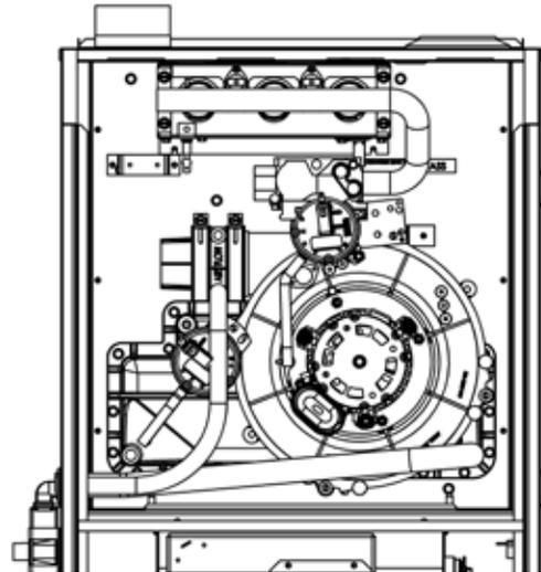
ÉVACUATION À GAUCHE - INSTALLATION DU DRAIN À GAUCHE
