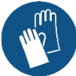
**Handschutz:** Spritzschutz: Einmalhandschuh aus Nitrilkautschuk z.B. Dermatril (Schichtdicke: 0,11 mm) der Fa. KCL oder Handschuhe anderer Hersteller mit gleichen Schutzwirkungen. Dauerkontakt: Schutzhandschuh aus Nitrilkautschuk z.B. Camatril (> 120 min, Schichtdicke: 0,40 mm) oder aus Butylkautschuk z.B. Butoject (>480 min, Schichtdicke: 0,70 mm) der Fa. KCL oder Handschuhe anderer Hersteller mit gleichen Schutzwirkungen.
