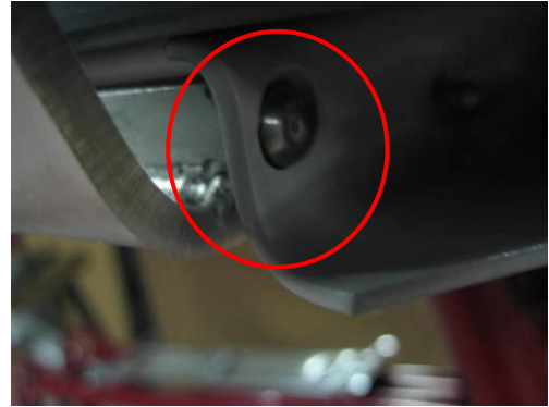
Die Reling ist korrekt verriegelt: Der Duschwagen ist sicher.
