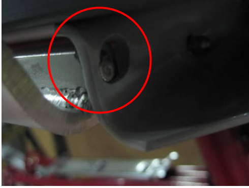
Die Reling ist nicht korrekt verriegelt: GEFAHR Die Reling könnte sich unerwartet öffnen.
