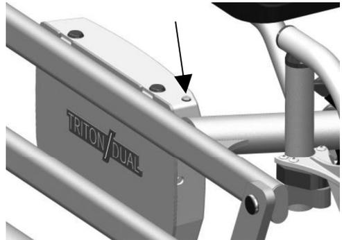
**Hinweis:** Nach Anschließen des Ladekabels können bis zu 15 Sekunden bis zum Aufleuchten der LED vergehen. Der Akku kann nicht überladen werden.
