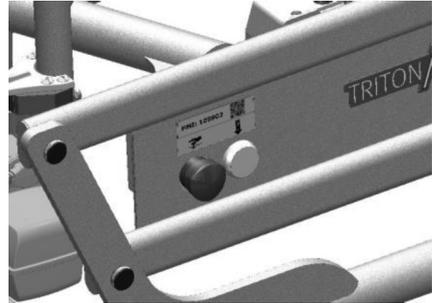
Der rote Not-Aus befindet sich neben dem Steuerungskasten. Zum Verriegeln drücken, zum Zurücksetzen drehen.
