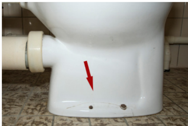
Scheur in toilet
