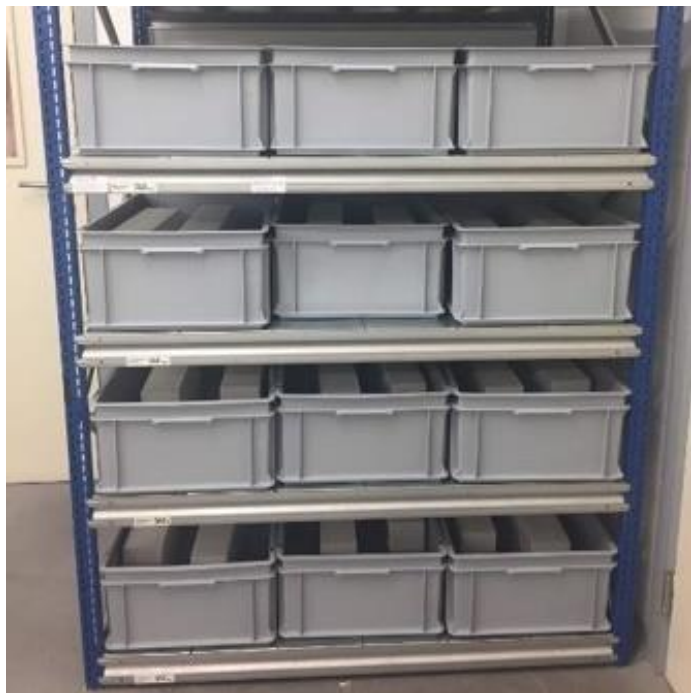
Фото 11 Випробувальні зразки зберігаються у воді протягом встановлених періодів.
