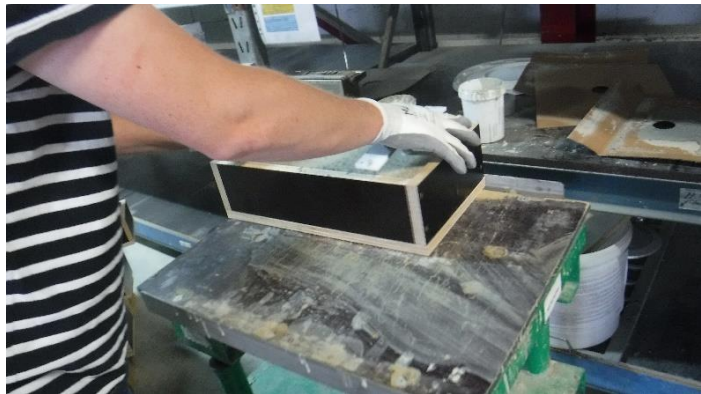
Фото 6 З бетону видаляють повітря на вібростолі.
