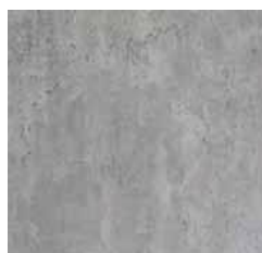
❑ Betonivalu, sileä matta BS
